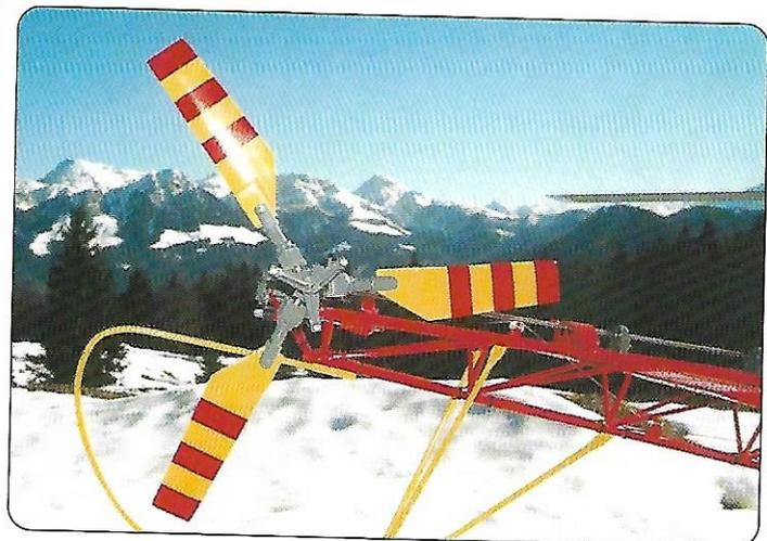
Neben dem vorbildgetreuen Dreiblatt-Heckrotor markante Bauteile im Heckbereich der Lama: Rotorblattabweiser (Spornbügel), Seilzuganlenkung des Heckrotors, Antikollisionslicht.
