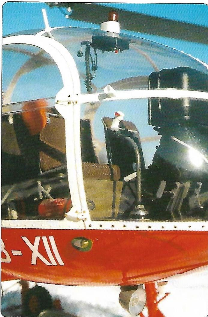
Gehört selbstverständlich zur obligatorischen Ausrüstung eines Scale-Modell dieses Kalibers: Landescheinwerfer, Antikollisionslicht, Blitzlicht oben, Kopfhörer, Steuerknüppel und Fußpedale, Sitze mit Kartentasche (links).
